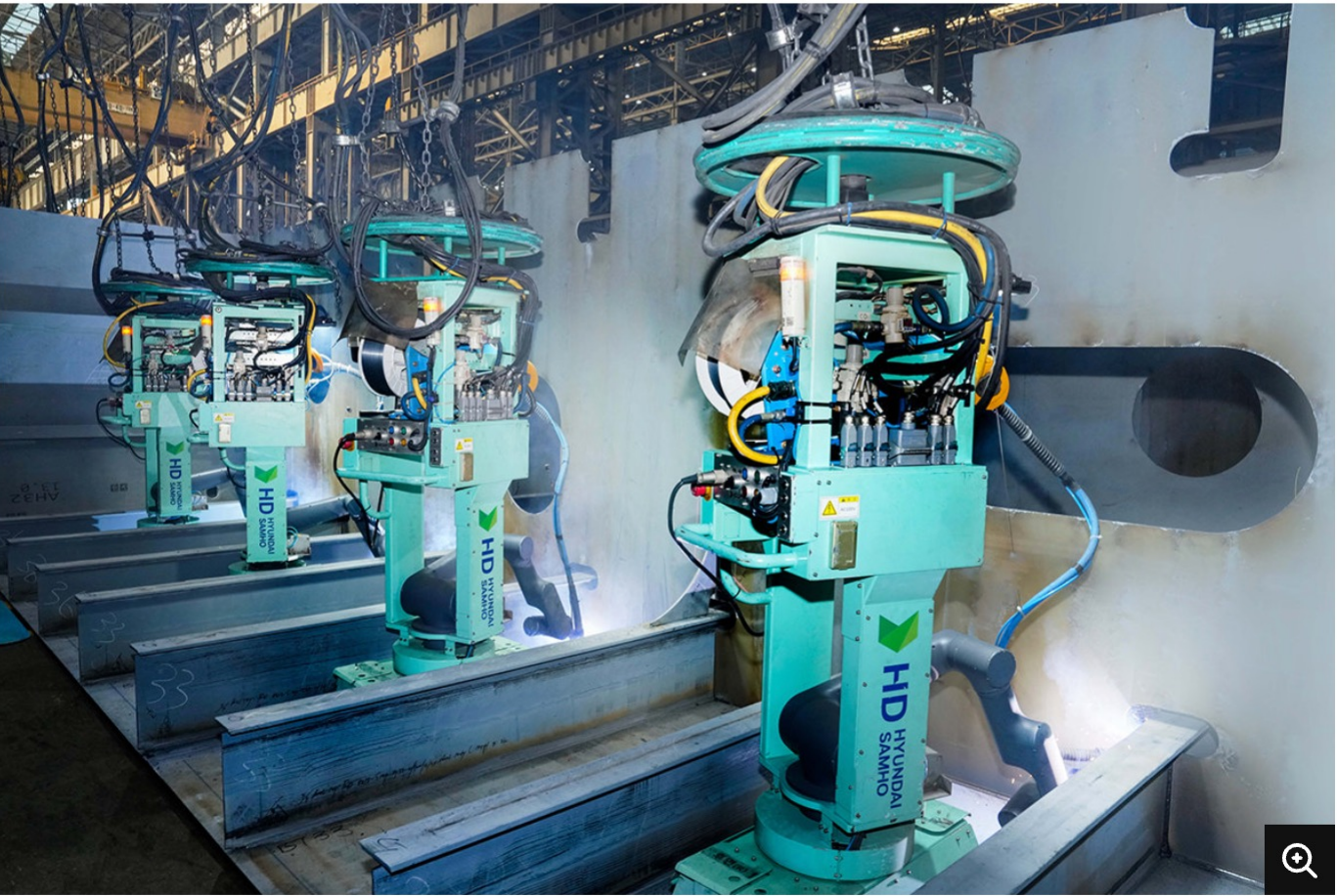
최근 전남 영암군 HD현대삼호 조선소의 패널 공장 실내 작업 현장에서 인공지능(AI) 용접 로봇들이 선박용 철판 용접을 하는 모습. 총 90대의 이 로봇 도입 후 이 회사 용접 작업의 결함은 10분의 1로 줄고 생산 효율은 15~20% 높아졌다. HD현대삼호 제공
